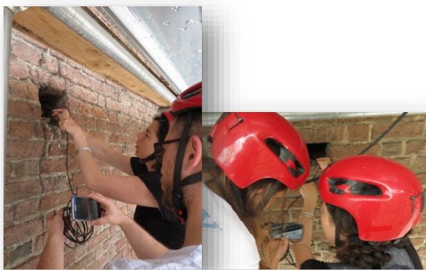
Ispezione delle buche pontaie tramite endoscopio.
