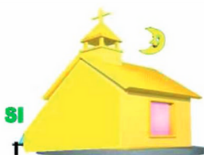
Figura 24 - L'illuminazione dal basso va riservata ai soli edifici di grande importanza storica. Il fascio di luce deve però rimanere interamente contenuto entro la sagoma dell'edificio.
