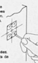
Placez le gabarit de la gâche sur le chambranle; alignez les axes avec les lignes tracées. Marquez les quatre points de centrage.
